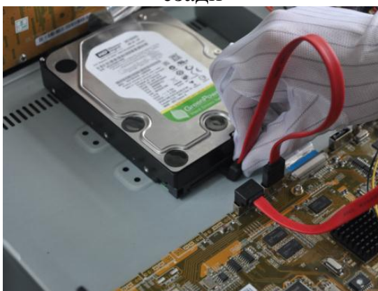
Подключите кабель данных и питания к HDD
