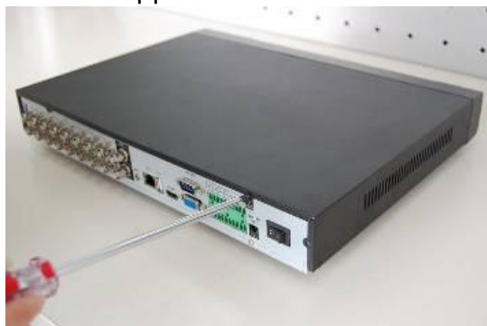
Открутите винты крепления крышки сзади
